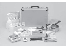
【ZAパーソナル】 携帯・設置併用型の土壤分析器
